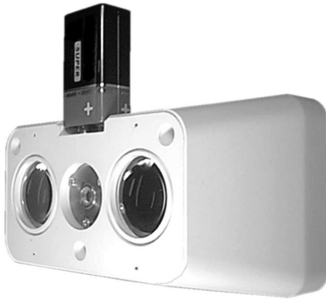
Fig. 2. Detector DOP-6001 durante el alineamiento del haz
